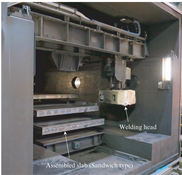
写真4 クラッドスラブ組立てラインの真空チャンバー入口 Photo 4 Entrance of vacuum chamber of clad slab assembly line
